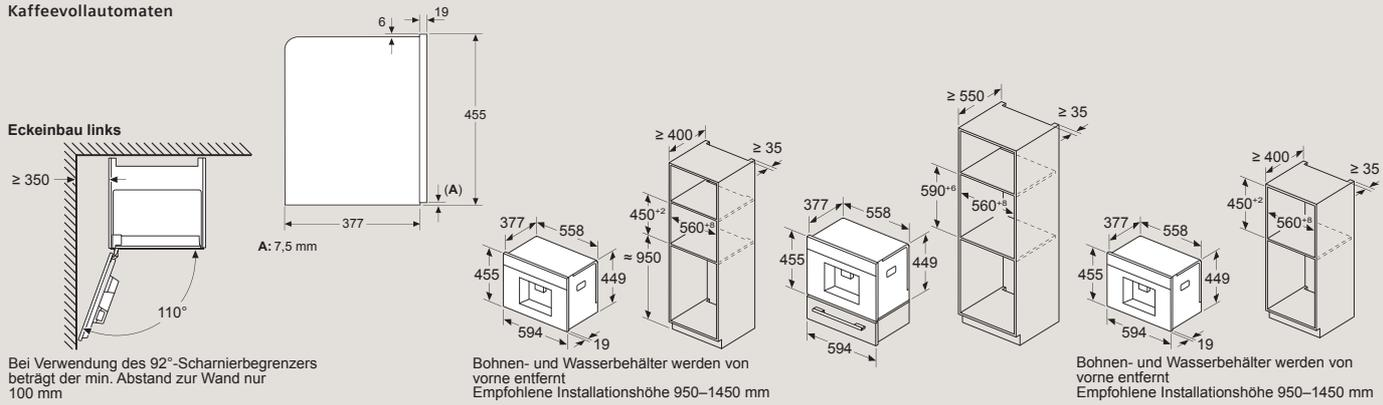
Bei Verwendung des 92°-Scharnierbegrenzers beträgt der min. Abstand zur Wand nur 100 mm
