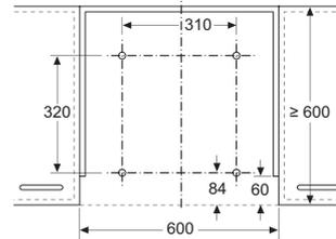
Montage Flachschrühhaube mit Absenkrahmen
