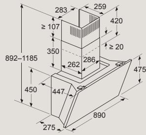
Gerät im Umluftbetrieb ohne Abluftkanal
