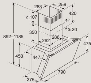
Gerät im Umluftbetrieb ohne Abluftkanal
