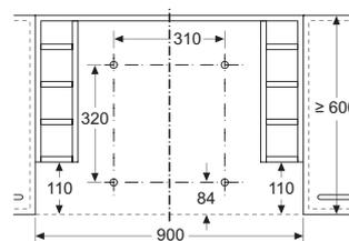
Montage Flachschriftmaube mit Absenkrahmen
