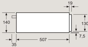
Über eine Vakuumierschublade können Kompakt-Backöfen mit einer Gerätehöhe von 455 mm eingebaut werden. Ein Zwischenboden ist nicht erforderlich.
