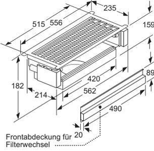
Frontabdeckung für Filterwechsel
