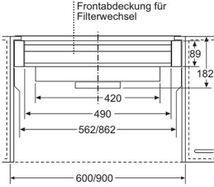
Frontabdeckung für Filterwechsel
