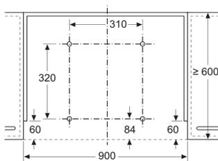
Montage Flachschriftmaube mit Absenkrahmen
